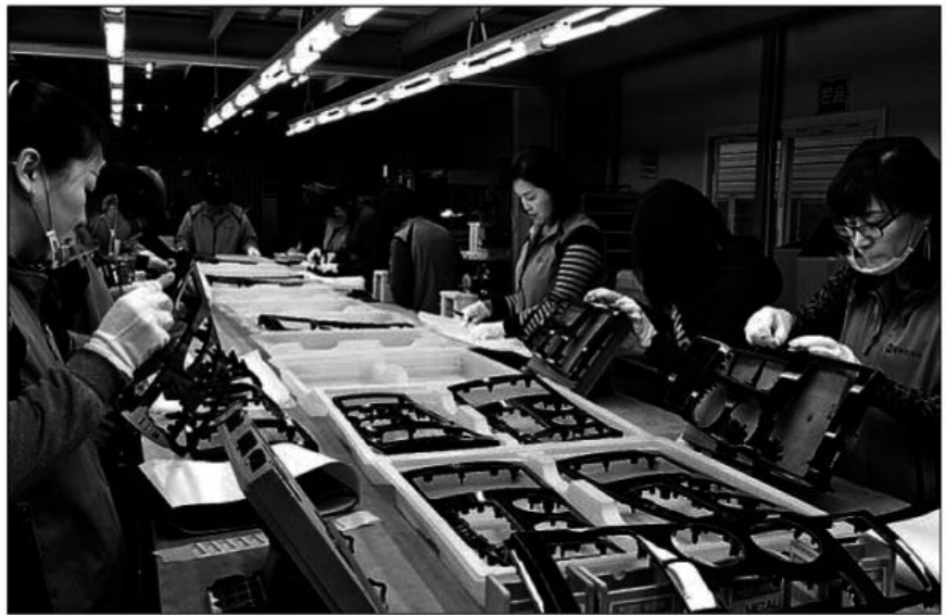
일을 그만 두었다가 뒤늦게 재취업한 여성 근로자들이 최근 영천의 여성친화인증기업인 대하인프라에서 자동차부품인 콘솔을 조립한 후 포장하고 있다.
